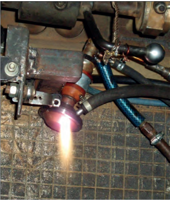
Рис. 2. Плазмотрон з криволінійним дуговим каналом
