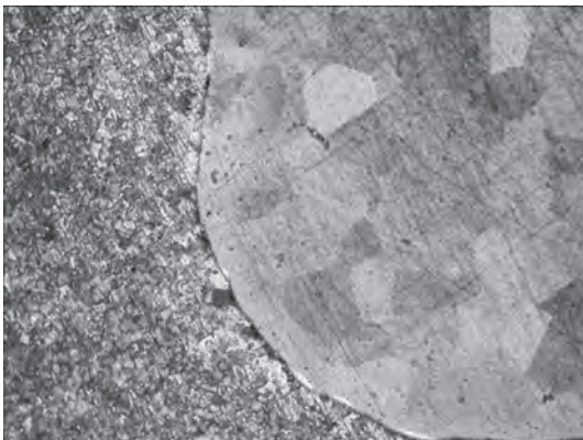
Рис. 4. Мікроструктура з'єднання латунь–сталь після травлення, \times 100
