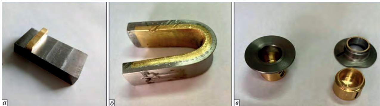
Рис. 8. Зразки для механічних випробувань з'єднань латунь–сталь: а – випробування на зріз плакуючого шару; б – двошарове з'єднання після випробувань на статичний вигин плакуючим шаром всередину; в – до і після випробувань на відрив плакуючого шару
