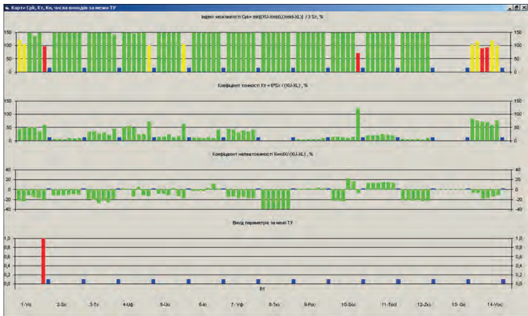
Рис. 4. Результати розрахунків Crk, nXout, Kn, Kt для окремої пліти (6 примірників), кожна з яких нараховує близько 40 стиків разом з контрольними зразками, вибірки протягом 2013–2020 рр. на машині K-1000
