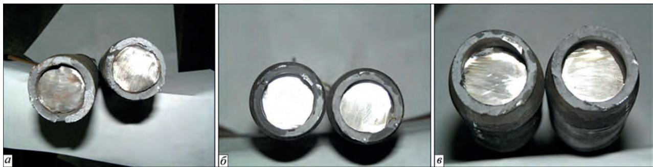
Рис. 4. Характер зламу зразків при випробуванні на розтягування: а – зразок з нульовим зазором; б – зразок з зазором 20 мм; в – зразок з зазором 40 мм
