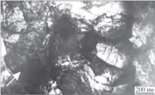
Рис. 9. Тонка структура ділянки неповної рекристалізації ЗТВ зварного з'єднання зі сталі 12Х1МФ. Зерно бейніту відпуску позначене стрілкою. Ресурс 280 тис. год
