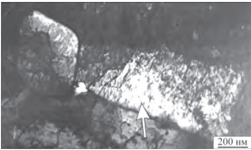
Рис. 11. Мікроструктура металу шва зварного з'єднання зі сталі 12Х1МФ. Ділянка зерна \alpha -фази із зменшеною щільністю дислокацій відзначена стрілкою. Ресурс 280 тис. год
