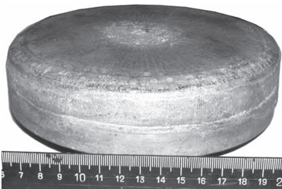
Рис. 1. Біметалічна заготовка діаметром 180 мм, призначена для приварювання до робочої поверхні, що зношується
