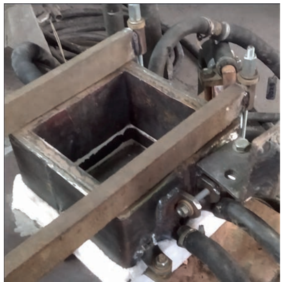
Рис. 2. Струмопідвідний двосекційний кристалізатор перетином 200×200 мм
