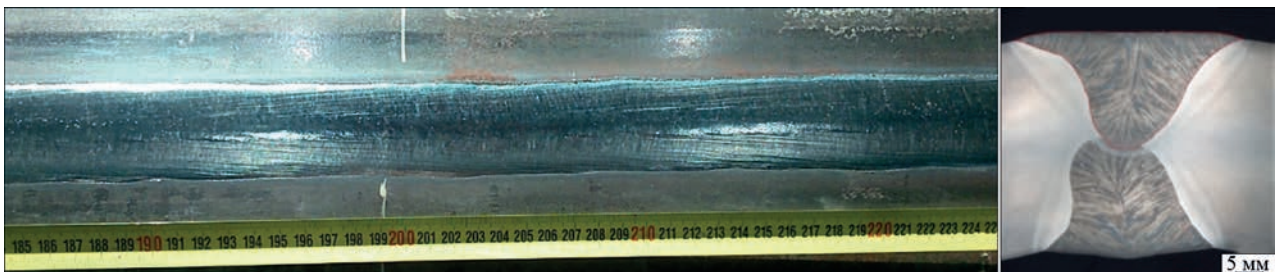
Рис. 2. Зовнішній вигляд і поперечний переріз зварного шва SAW. Зовнішній шар зварений з такою конфігурацією дроту: d_{1,2} = 4,8 мм і d_{3,4,5} = 4 мм; V = 1,1 м/хв, I_1 = 1480 А, U_1 = 34 В; I_2 = 1200 А, U_2 = 38 В; I_3 = 760 А, U_3 = 38 В; I_4 = 650 А, U_4 = 38 В; I_5 = 650 А, U_5 = 38 В
