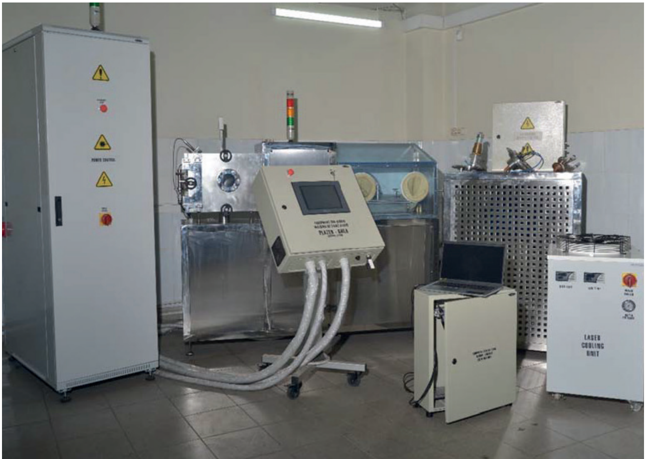
Рис. 9. Комплекс для лазерного, мікроплазмового і лазерно-мікроплазмового зварювання в контрольованій атмосфері та в динамічному вакуумі
