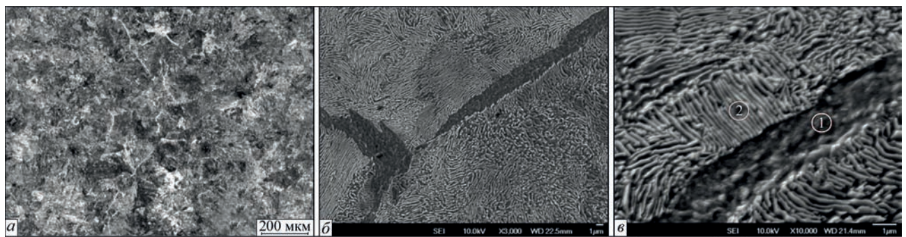
Рис. 7. Лінія з'єднання рейок з заєвтектоїдної сталі марки AREAL 136HE-X: а, б – мікроструктура (×100, ×3000); в – результати Оже-спектрального аналізу (ат. %)
