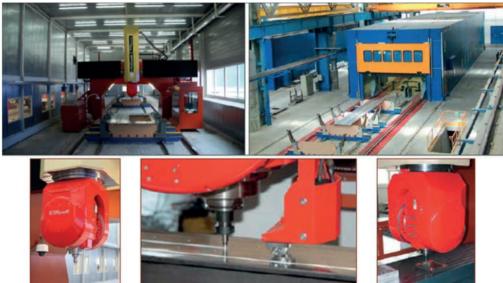
Рис. 7. Приклад обладнання HAGEMATIC 305 FSW з фрезерно-зварювальною головою STIRPOWER 300 для високошвидкісного фрезерування та ЗТП для з'єднання габаритних плоских секцій
