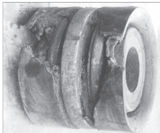
Рис. 8. Зовнішній вигляд поршня з гумовими манжетами після досліджень втулки, яку наплавлено порошком сплаву Н75Х15С4Р4
