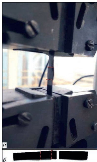
Рис. 2. Зовнішній вигляд напускного зварного з'єднання полі(ДГЕБА/Т 3 М)/ГО плівок в процесі проведення випробувань на розтяг (а) та після руйнування (б)
