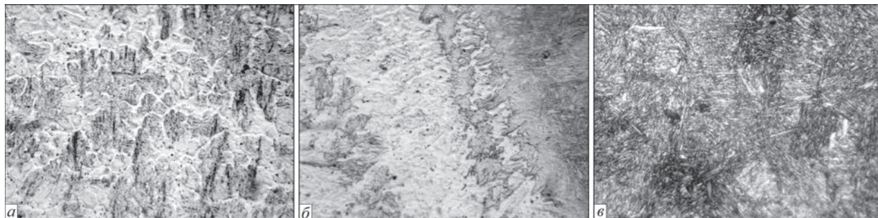
Рис. 3. Мікроструктура ( \times 500 ) з'єднання сталі 30X2H2MDF при ІДЗ на форсованому режимі: a – шов; б – лінія сплавлення; в – ділянка крупного зерна ЗТВ
