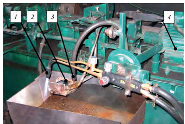
Рис. 2. Вигляд блока установки для дослідження термостійкості наплавлених зразків: 1 – газовий пальник для підігріву зразка; 2 – досліджуваний зразок; 3 – шланг для подачі води, що охолоджує зразок; 4 – привід переміщення зразка
