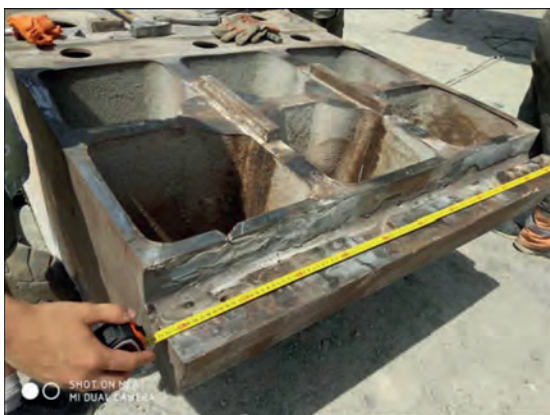
Рис. 1. Конструктивні особливості корпусу шатуна
