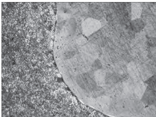
Рис. 4. Мікроструктура з'єднання латунь–сталь після травлення, \times 100
