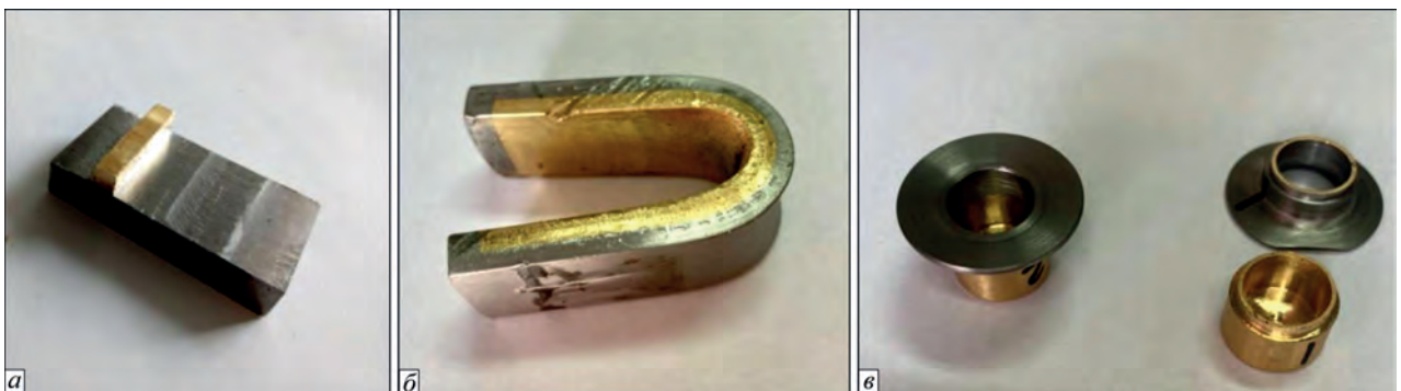
Рис. 8. Зразки для механічних випробувань з'єднань латунь-сталь: а – випробування на зріз плакуючого шару; б – двошарове з'єднання після випробувань на статичний вигин плакуючим шаром всередину; в – до і після випробувань на відрив плакуючого шару
