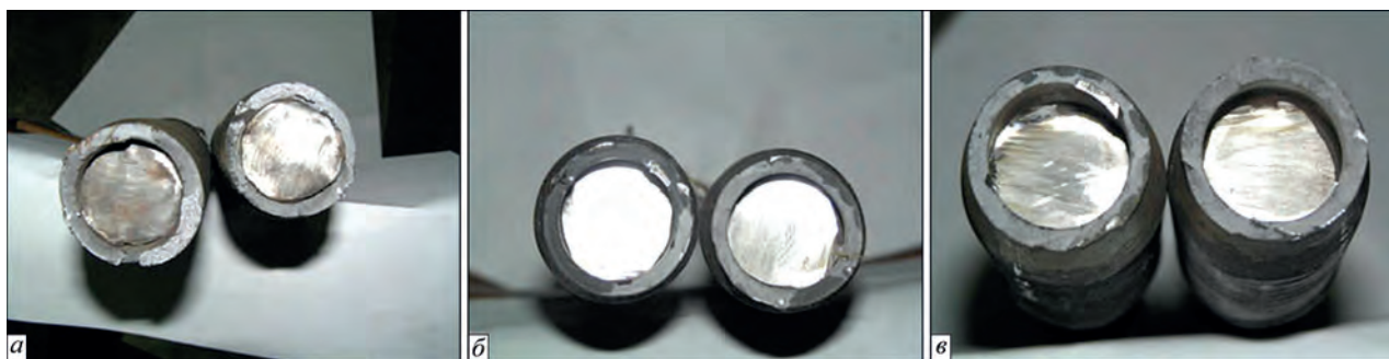
Рис. 4. Характер зламу зразків при випробуванні на розтягування: a – зразок з нульовим зазором; b – зразок з зазором 20 мм; c – зразок з зазором 40 мм
