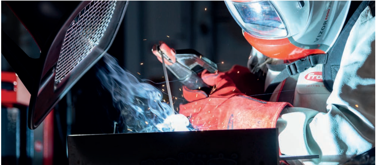
Потужна система відведення диму Exento LowVac із гнучким рукавом здатна ефективно очищувати великі робочі площі
