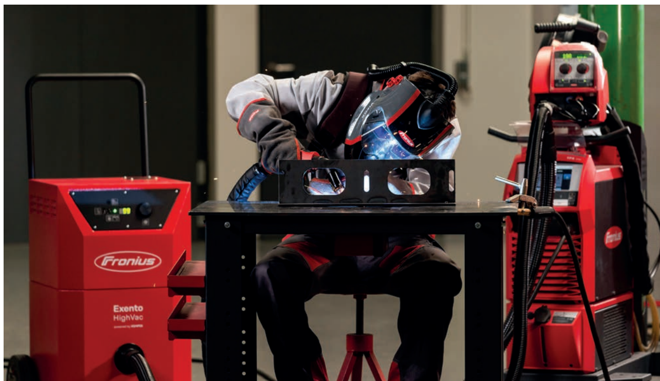
Злагоджений дует від одного виробника: система відведення диму Exento HighVac та ергономічний пальник із димовідведенням Exento
