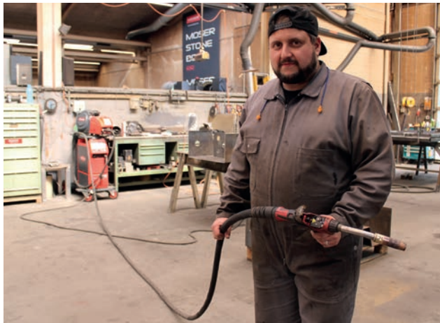
Зварювальний пальник підключено до зварювальної системи за допомогою 10-метрового шлангового пакета
