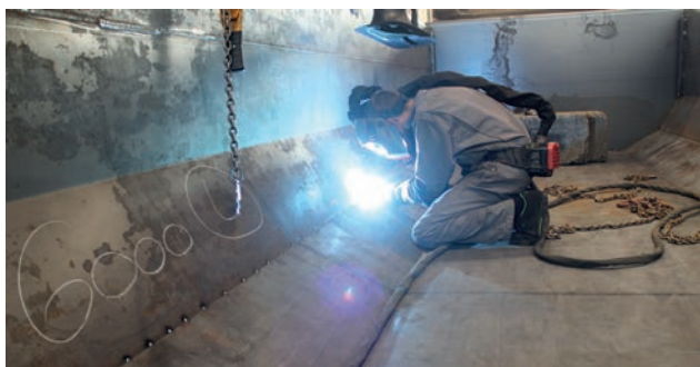
Зварювальна дуга PMC під час зварювання компонентів самоскида
