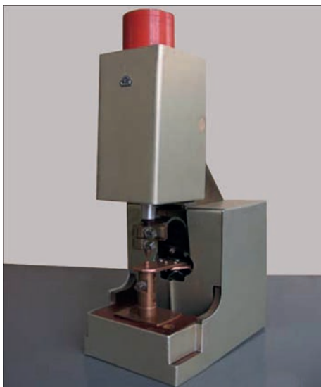
Рис. 1. Загальний вигляд машини для контактного мікрозварювання на змінному струмі підвищеної частоти
