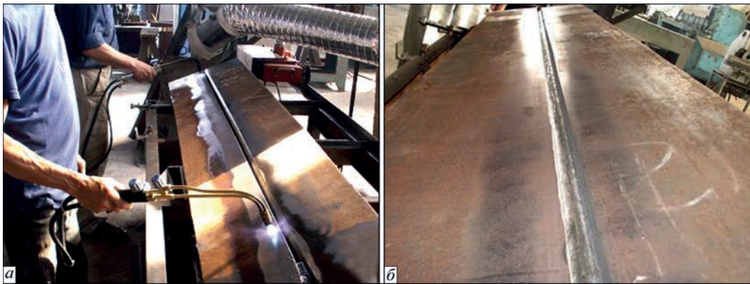
Рис. 1. Зовнішній вигляд контрольних зварних з'єднань до (а) та після (б) зварювання
