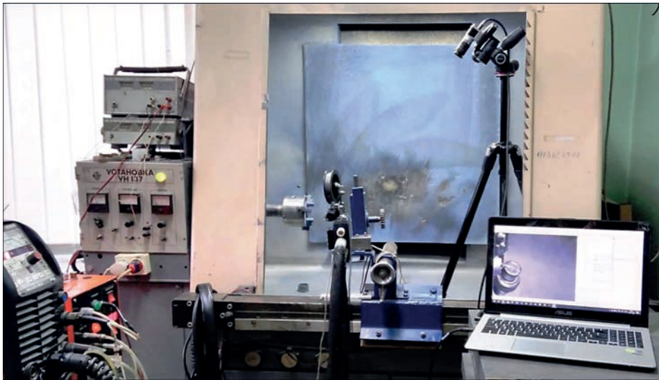
Рис. 1. Експериментальний стенд для дослідження швидкості руху диспергованих частинок
