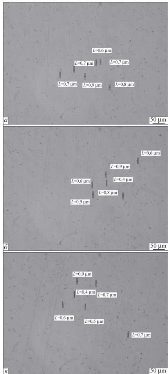
Рис. 5. Неметалеві включення та їх розмір у металі шва, виконаного дротом «Thermanit» 13/04 Si у захисній газовій суміші Микс 1: а – верхня частина шва, \times 1000 ; б – середня частка шва, \times 1000 ; в – нижня (коренева) частка шва
