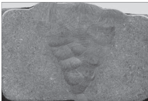
Рис. 4. Макрошліф зварного з'єднання сталі СА-6NM
