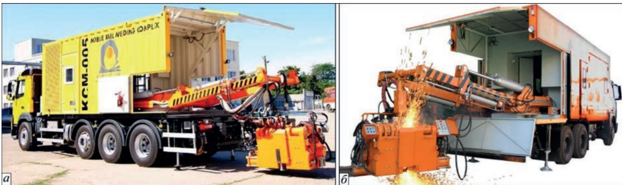
Рис. 14. Рейкозварювальний комплекс KCM 005 на комбінованому шасі, оснащений машиною K920 (а), K922-1 (б)
