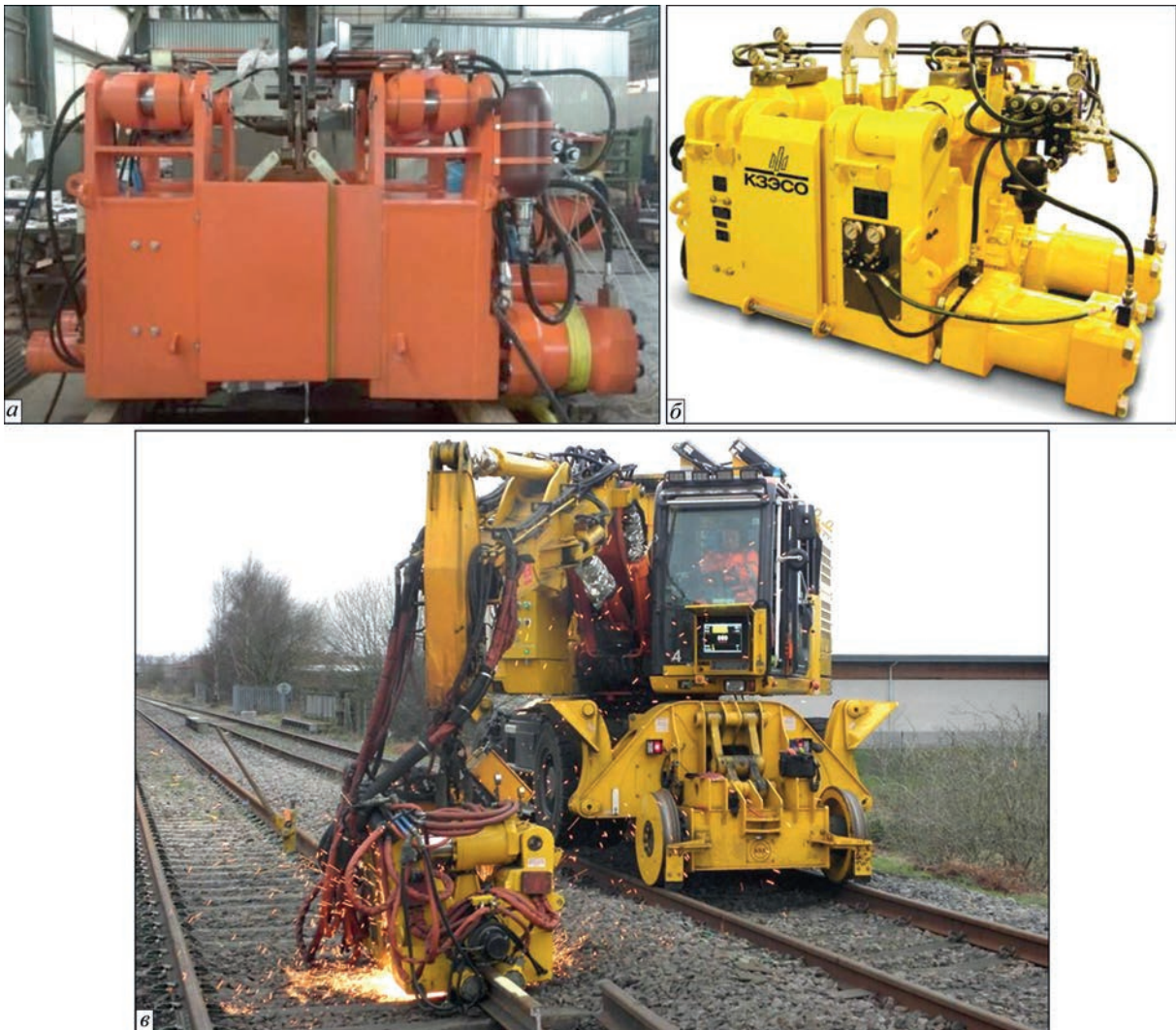
Рис. 12. Мобільні машини K960 (а), K945 (б), рейкозварювальний комплекс з машиною K945 (в) для КСЗ рейок з «натягом»
