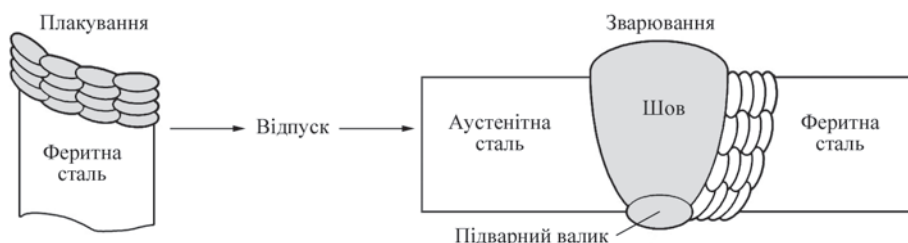
Рис. 1. Схема виконання зварного з'єднання з попереднім плакуванням
