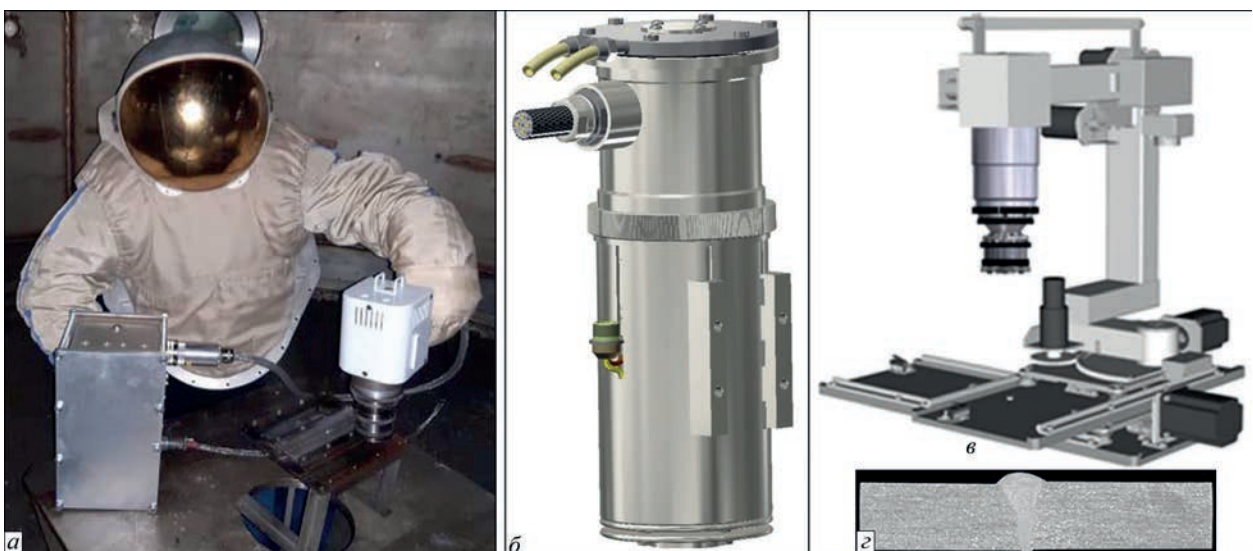
Рис. 8. Ручний електронно-променевий інструмент нового покоління та гармата для зварювання і 3D-принтіngu для довготривалої роботи: а – прототип комплексу ручного інструменту, випробуваний при виконанні технологічних експериментів; б – загальний вигляд електронно-променевої гармати для зварювання в космосі в складі маніпулятора або робота; в – спеціальний маніпулятор з 5-ма ступенями свободи, створений для виконання процесу автоматичного зварювання; з – макроструктура алюмінієвого сплаву АМг6 завтовшки 8 мм
