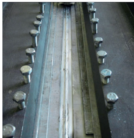
Рис. 3. Зовнішній вигляд зварного з'єднання сплаву АМг5М в збирально-зварювальному пристрої одразу після закінчення плазово-дугового зварювання різнополярним асиметричним струмом зі швидкістю 200 см/хв
