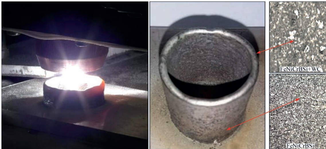
Рис. 18. Процес виготовлення циліндричної заготовки інструменту обробки металів шляхом АПДН порошків зносостійкого сплаву FeNiCrBSi і карбиду вольфраму WC (а, б) та мікроструктура виробу в різних зонах (в)
