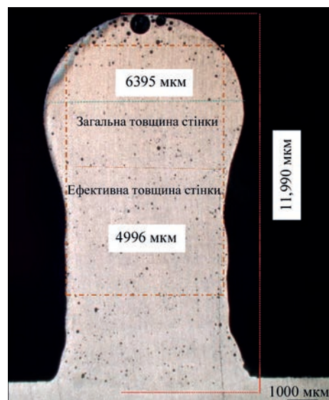
Рис. 10. Результат якісного АПДН на змінному струмі об'ємного елемента у вигляді багатошарової стінки зі сплаву AA2319 системи Al-Cu-Li [19]
