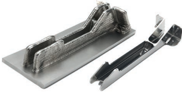
Рис. 14. Приклад надрукованих авіаційних деталей із титанових сплавів до і після механічної обробки, отриманих АПДН у контрольованому середовищі в компанії Norsk Titanium, Нідерланди
