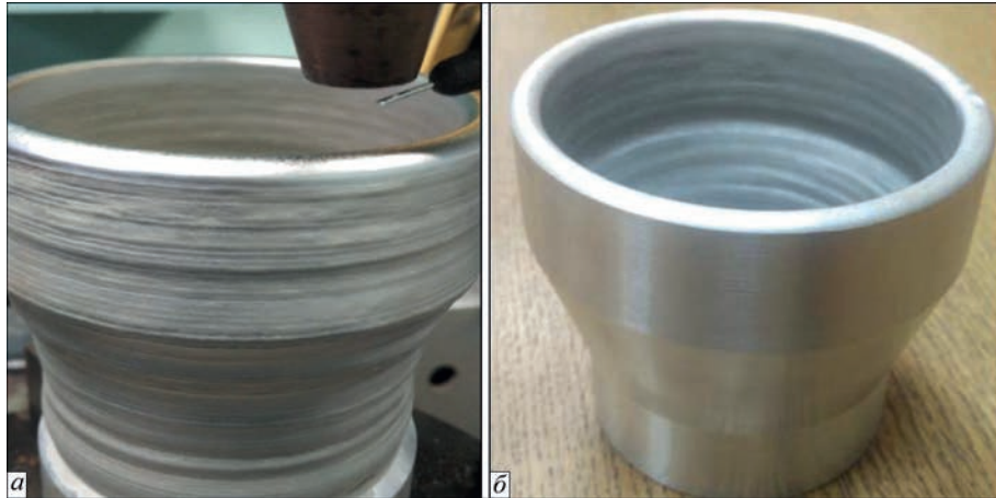
Рис. 8. Перехідник з алюмінієво-магнієвого сплаву 1580, виготовлений АПДН на постійному струмі зворотної полярності [17]: зовнішній вигляд після 3D друку (а) та після механічної обробки (б)
