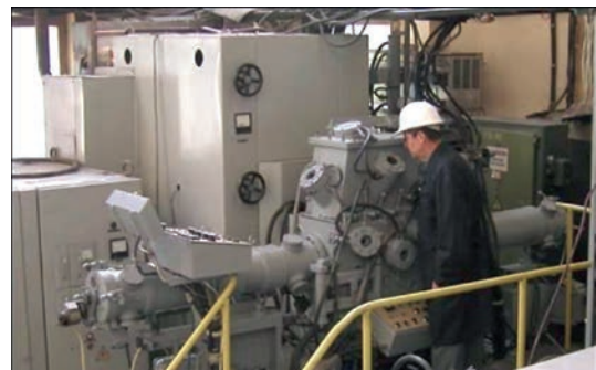
Рис. 3. Установка для вирощування монокристалів тугоплавких металів у вигляді пластин
