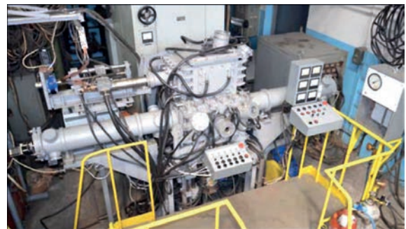
Рис. 5. Новітня установка з комп'ютерним керуванням для вирощування монокристалів тугоплавких металів у вигляді тіл обертання
