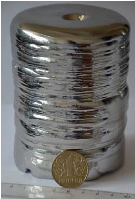
Рис. 7. Зовнішній вигляд кристалу вольфраму діаметром 85 мм у установці кристал безперервно обертається навколо вертикальної осі. У якості зародкового кристала використовується циліндрична заготовка, виготовлена з плоского монокристалу заданої орієнтації. На рис. 6 представлено фото процесу вирощування монокристала, де стрілками наведено напрямки подачі витратного прутка у зону плавлення плазмової дуги та напрямки обертання монокристала.
