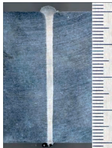
Рис. 1. Поперечний шліф з'єднання плит сплаву 2219, завтовшки 40 мм
