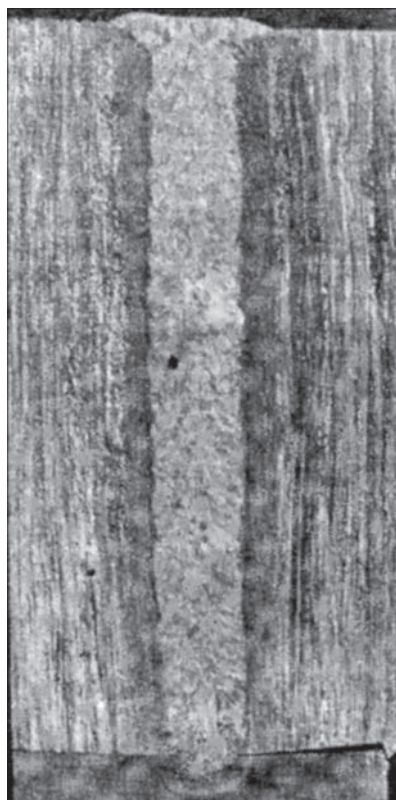
Рис. 3. Макрошліф зварного з'єднання сплаву АТЗ завтовшки 110 мм ( I_{\text{зв}} = 420 А, U_{\text{д}} = 13 В, V = 8 м/год)
