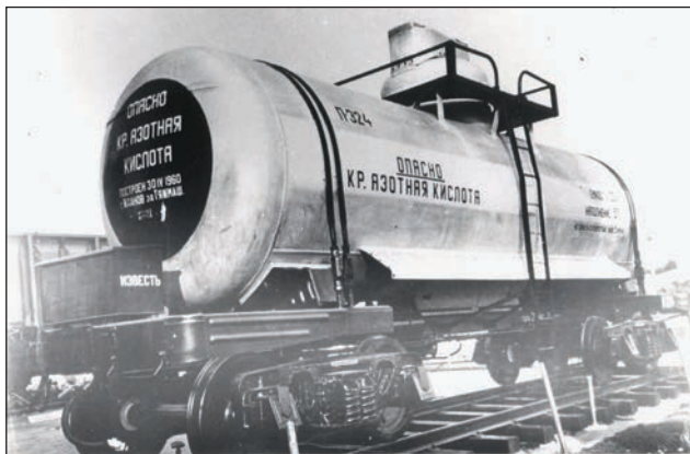
Зварна залізнична цистерна з алюмінієвого сплаву для перевезення компонентів ракетного палива
