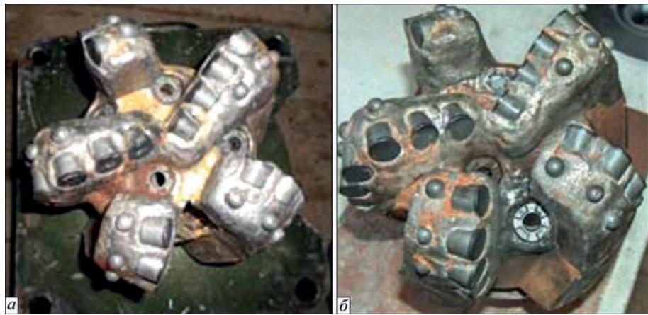
Рис. 9. Сталеve долото діаметром 215,9 мм: а – до ремонту; б – після ремонту
