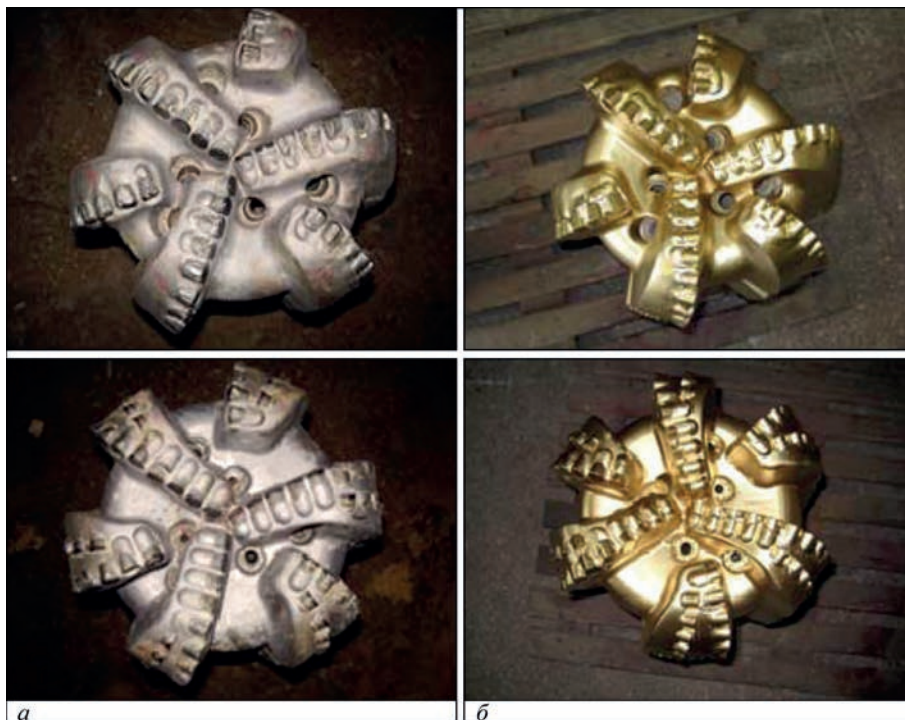
Рис. 10. Матричні бурові долота діаметром 311,1 мм: а – до ремонту; б – після ремонту
