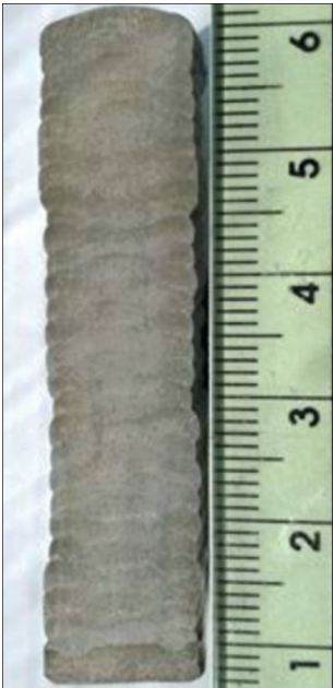
Рис. 3. Макрошліф наплавленої деталі
