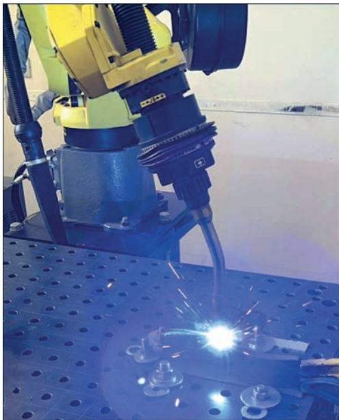
Рис. 2. Процес роботизованого наплавлення деталі
