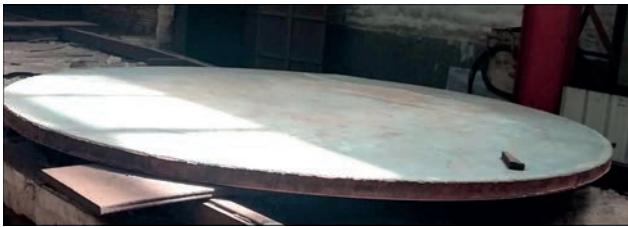
Рис. 7. Вигляд біметалевої трубної дошки TA10-09Г2С діаметром 3340 мм після термічної обробки
