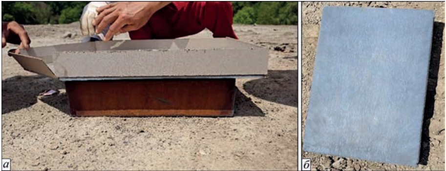
Рис. 1. Зовнішній вигляд пластин з титанового сплаву Grade12 і вуглецевої сталі 09Г2 перед зварюванням вибухом (а) і після нього (б)
