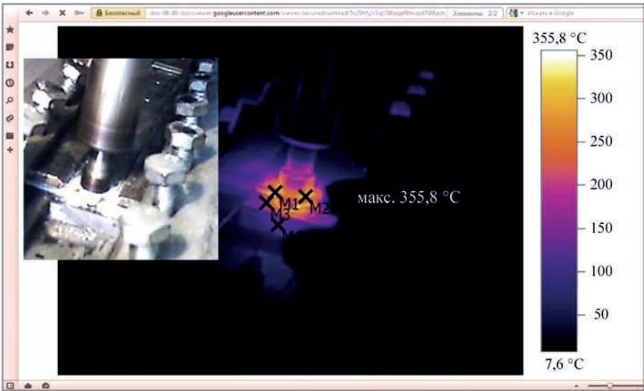
Рис. 1. Термограма температурного поля при ЗТП стикового з’єднання магнієвого сплаву товщиною 2 мм (Fluke Ti25)
