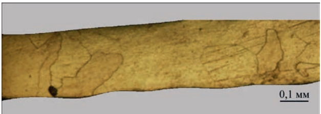
Рис. 6. Мікроструктура зварного з’єднання міді \delta = 0,2 мм, виконаного за технологічною схемою III
