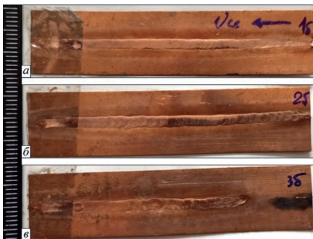
Рис. 4. Зовнішній вигляд зварних швів, виконаних по технологічній схемі зварювання I при I_{\text{зв}} , А: а – 20; б – 22; в – 24
