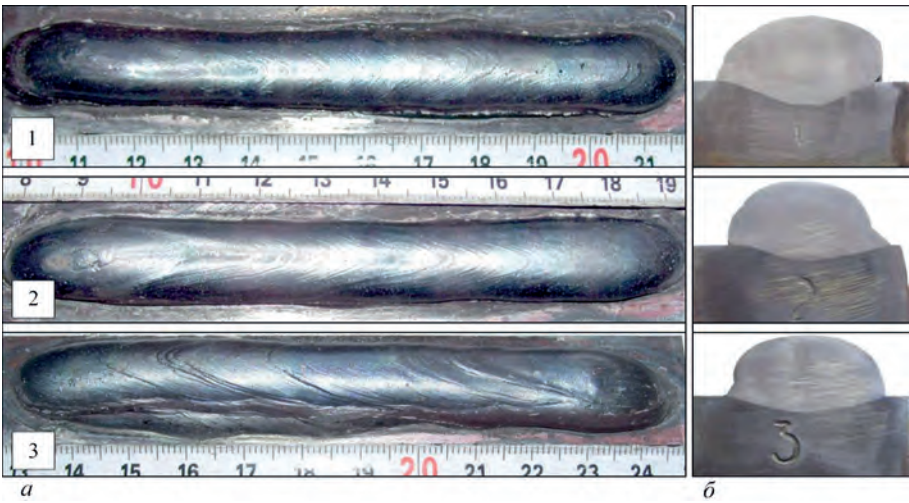
Рис. 1. Зовнішній вид зразків, наплавлених дротами № 1–3 в п’ять шарів (а) та їх поперечні макрошліфи (б)
