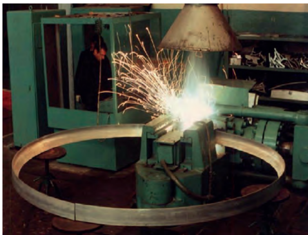
Зварювання шпангоута на «Південному машинобудівному заводі»
