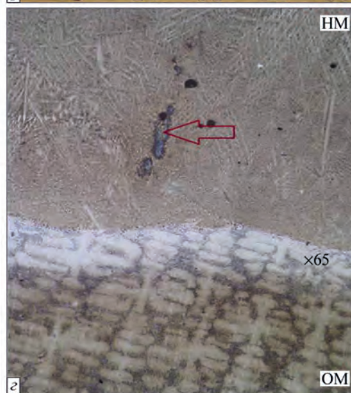
Рис. 8. Закономірності утворення тріщин в зварному з'єднанні «50 % основного (ОМ) + 50 % наплавленого (НМ) металу» НЖС типу ЖС32, виконаному одношаровим мікроплазмовим порошковим наплавленням сплаву ЖС32 з q_{\text{н}} = 380 \dots 450 Вт та q_{\text{н}}/\nu = 2000 \dots 3000 Дж/мм: а – схема підготовки зварної заготовки та вирізки зразка для механічних випробувань; б – зовнішній вид одношарового наплавлення; в – результати капілярного контролю після видалення бокових підсилень наплавленого валика; г – зовнішній вид тріщин в наплавленому металі ЖС32, виявлених при металографічному контролі
