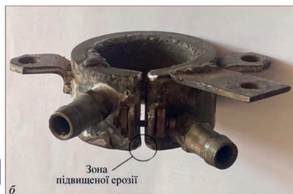
Рис. 3. Зони ерозії струмопідвідної секції, що активно протікає, на схемі наплавлення (а) і в СПК діаметром 70 мм (б)
