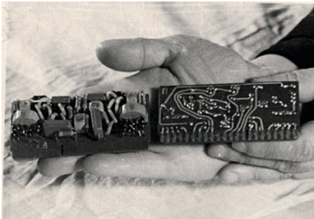
Лицьова і зворотня сторони однієї із 2300 стандартних комірок машини «Днепр»
