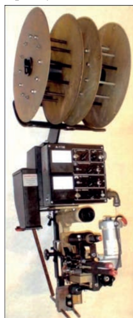
Рис. 2. Зовнішній вигляд макетного зразка монтажного апарата для зварювання вертикальних стиків
