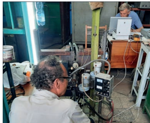
Рис. 4. Зварювання під флюсом вертикального стику завтовшки 20 мм з примусовим формуванням
