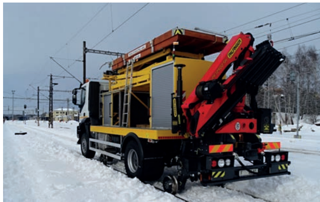
Двдорожня машина IT DUOLINER оснащена робочою платформою з ножицями для виконання робіт із технічного обслуговування залізниці, гідравлічним краном та вимірювальним пантографом
