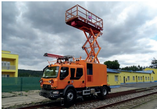
Двдорожня машина R DUOTRAM H застосовується на автомобільних дорогах, залізничних і трамвайних коліях переважно для обслуговування контактних ліній
