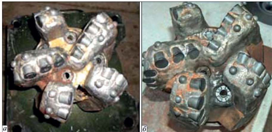
Рис. 9. Сталеve долото діаметром 215,9 мм: а – до ремонту; б – після ремонту
