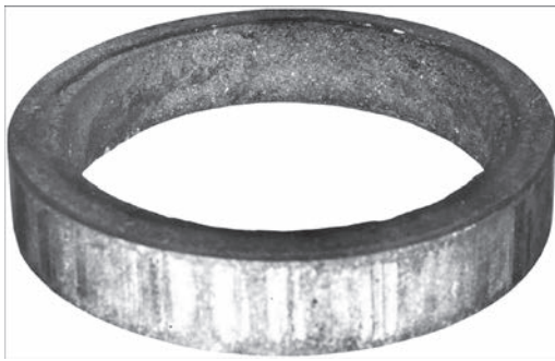
Рис. 2. Захисна графітова втулка зі слідами ерозії після експлуатації протягом приблизно 10 год
