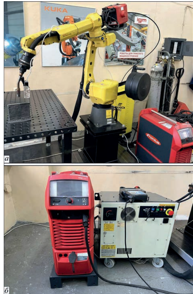
Рис. 1. Роботизований комплекс для багат шарового наплавлення: а – робот Fanuc ARC Mate 100iC/7L; б – джерело струму Fronius TPS 320i Pulse з контролером
