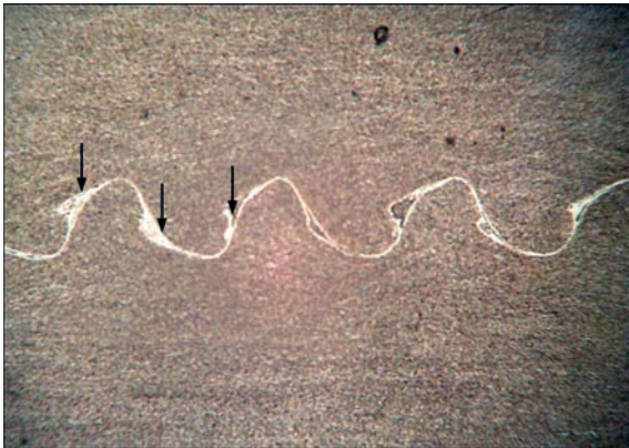
Рис. 7. Мікроструктура зони ЗВ пластин з ODS сталі
