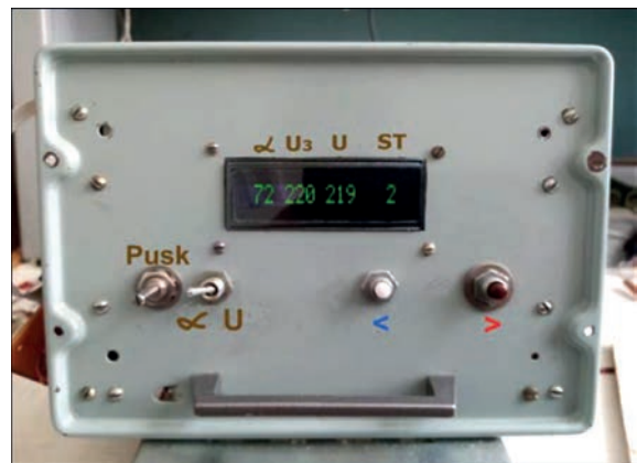
Рис. 8. Вигляд лицевої панелі блоку керування регулювання вихідної напруги джерела складають 197...268 В (рис. 7, б).
