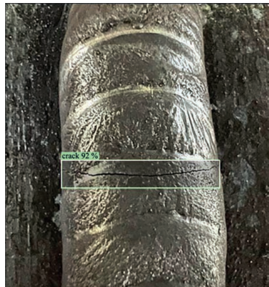
Рис. 4. Результат розпізнавання та класифікації поверхнього дефекту наплавленого шару
