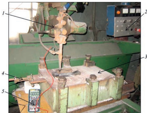
Рис. 1. Зовнішній вигляд лабораторної установки для наплавлення: 1 – зварювальний автомат А-1406; 2 – пульт керування; 3 – зварювальний стіл із закріпленням дослідним зразком; 4 – вимірювальний шунт; 5 – цифровий самописний мультиметр ANENG AN9002
