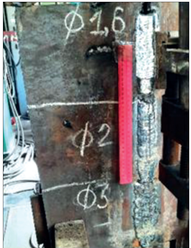
Рис. 1. Зовнішній вигляд зварних швів, отриманих при ЕШЗ зразка завтовшки 20 мм з використанням електродних дротів діаметром 1,6 мм (Св-08Г2С), 2,0 мм (Св-08ХГ2СМА) і 3,0 мм (Св-10НМА)
