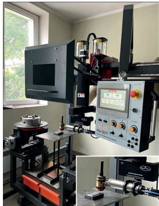
Рис. 1. Установа для плазмово–порошкового наплавлення з двома живильниками порошку та плазмотроном PP–6–03
