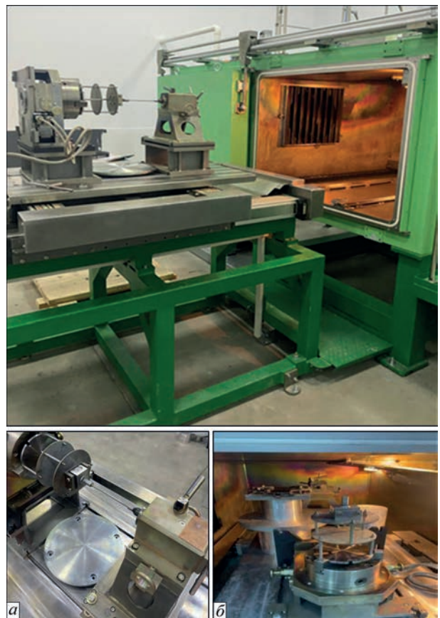
Рис. 1. Установа КЛ-211. Пристосування для складання та зварювання імітатора газового клапана у двох просторових положеннях: з горизонтальною (а) та з вертикальною віссю обертання (б)
