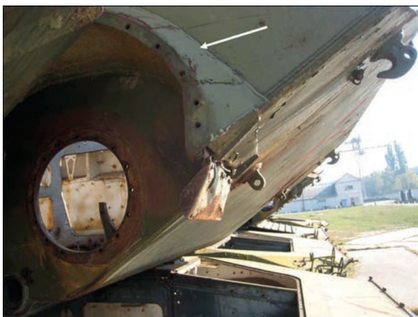
Рис. 1. Тріщина втомі в зварному з'єднанні виробу ЛБТ після довготривалої експлуатації
