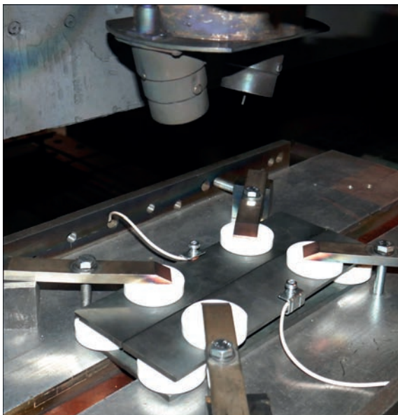
Рис. 5. Експериментальне вимірювання потужності променя, що екранується технологічною накладкою
