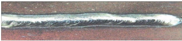
Рис. 5. Зовнішній вигляд металу шва при наплавленні з використанням квазііндукона
