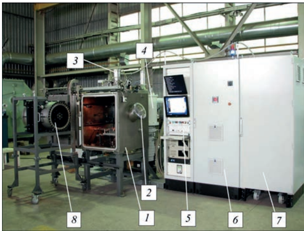
Рис. 3. Установка СВ 229 для електронно-променевої обробки: 1 – вакуумна камера; 2 – оглядовий ілюмінатор; 3 – електронно-променева гармата; 4 – вакуумна система; 5 – шафа керування; 6 – силова шафа; 7 – шафа зварювального високовольтного джерела живлення; 8 – завантажувальний пристрій для барабаних магазинів деталей
