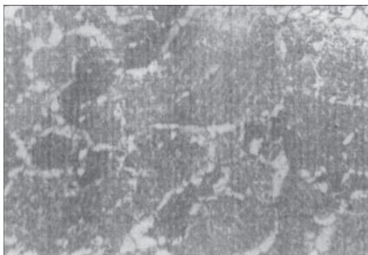
Рис. 7. Мікροструктура ділянки неповної перекристалізації ЗТВ зварного з'єднання зі сталі 15Х1М1Ф. Ресурс 280 тис. год (×2500)
