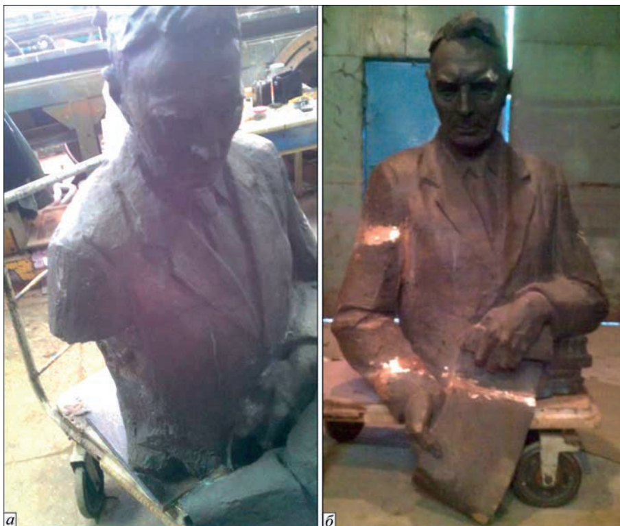
Рис. 13. Пам'ятник В.І. Толубинському з відбитою рукою (а) та після зварювання покритими електродами (б)
