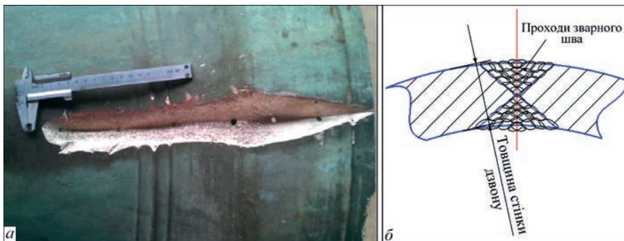
Рис. 6. Зовнішній вигляд обробленої тріщини (а) і схема зварювання тріщини (б)
