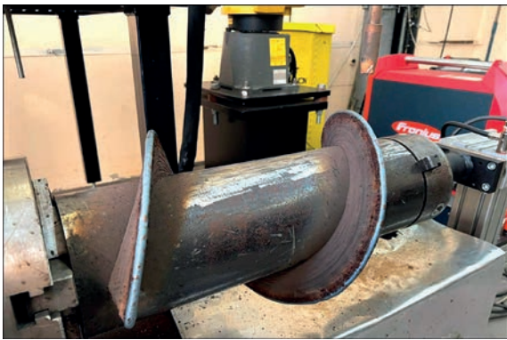
Рис. 5. Наплавлений фрагмент бурового шнека
