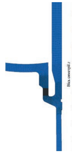
Рис. 6. Скінченно-елементна осесиметрична 2D модель вузла зварного з'єднання № 111
